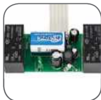
Два встроенных реле на токи до 16 А
