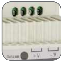
Сдвоенные клеммы питания для удобного подключения
