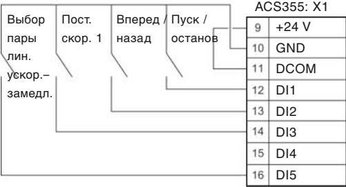
Конфигурация цифровых входов (DI) (подключение PNP) (приемник)
